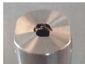
スラリー液による噴口部の摩耗
